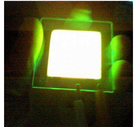
特殊な防湿膜のフィルム基板上で発行する緑色有機 E L 素子。=熊本県産業技術センター提供
